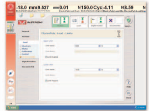
▲ Au déclenchement d'une limite programmée par l'utilisateur, Console affiche clairement l'état de votre système ElectroPuls.
