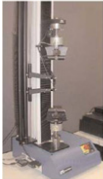
Essai en traction de tuyaux chirurgicaux à paroi mince avec un extensomètre à course longue
